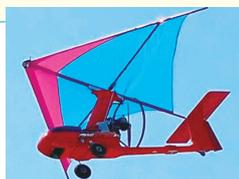
都市部を含めたドローンの利活用に不可欠な、安全なドローンの研究・開発が進んでいます。この「カイトプレーン」は凧のような翼が付いたドローン。この翼そのものがパラシュート構造を持つため、エンジンを停止しても直ぐには墜落せず長く滞空し、地上との衝突エネルギーを緩和できます。
