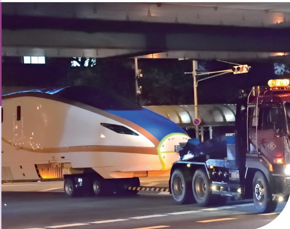
電柱、橋桁、電車の車体、ビルの鉄骨、建設機械や風力発電の羽、人工衛星のロケットなどは、そのもの自体を小さくしたり分割したり重量を軽くしたりすると、本来の強度や精度が保てなくなります。このような大きなものを運ぶ際のトレーラーや、一定の重さや大きさを超えるクレーン車などが特殊車両と呼ばれます。
